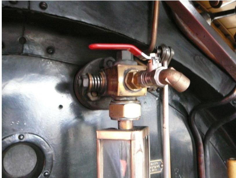
Stirnseitig eingeschraubtes Kugelventil am oberen Ventilkopf.
