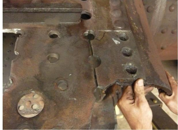
*Blechmaterial Wasserseite geöffneten Riss*
