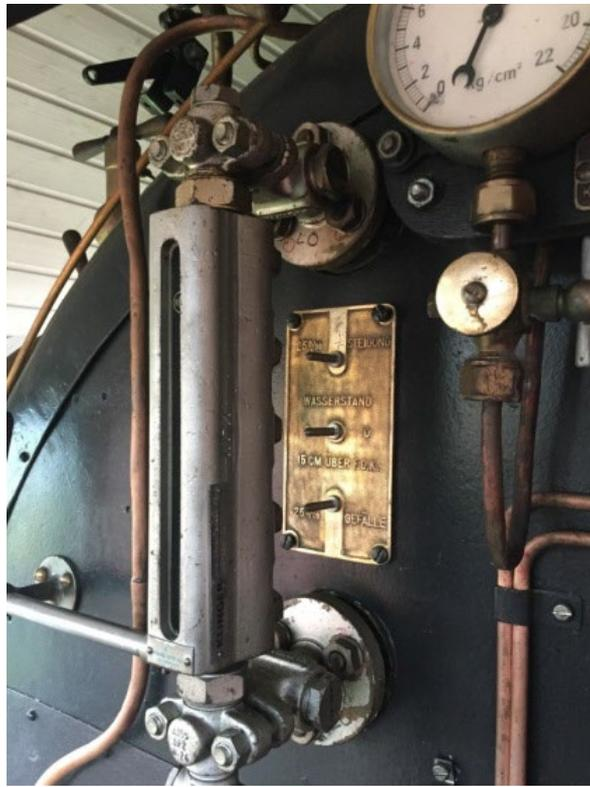
Wasserstand-Schild mit fest montierten Markierungen: NW (100mm über FB) bei 25‰ Steigung,
