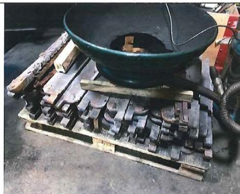
Bild 8 Ausgebauter Planrost
