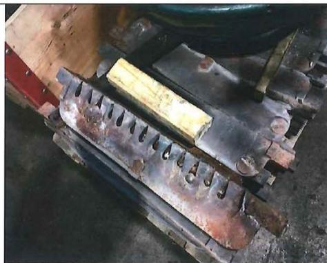
Bild 7 Ausgebauter Planrost
