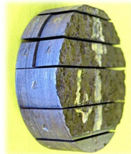
Die Entnahme von Bohrkernen zur Ermittlung von Materialeigenschaften eignet sich besonders für alte Kessel aus Puddelstahl, bei denen die Schweisseignung sehr kritisch ist. Die Bohrungen können mit einer Gewindescheibe wieder verschlossen werden, vorausgesetzt, die Ausschnitte sind durch den Wandungsüberschuss genügend verstärkt.
