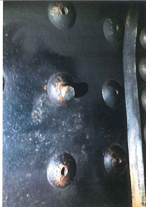
Bild 5 Vernagelter Stehbolzen in der rechten Seitenwand der Feuerbüchse
