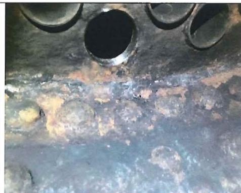
Bild 4 Materialabtrag in der Rauchkammer
