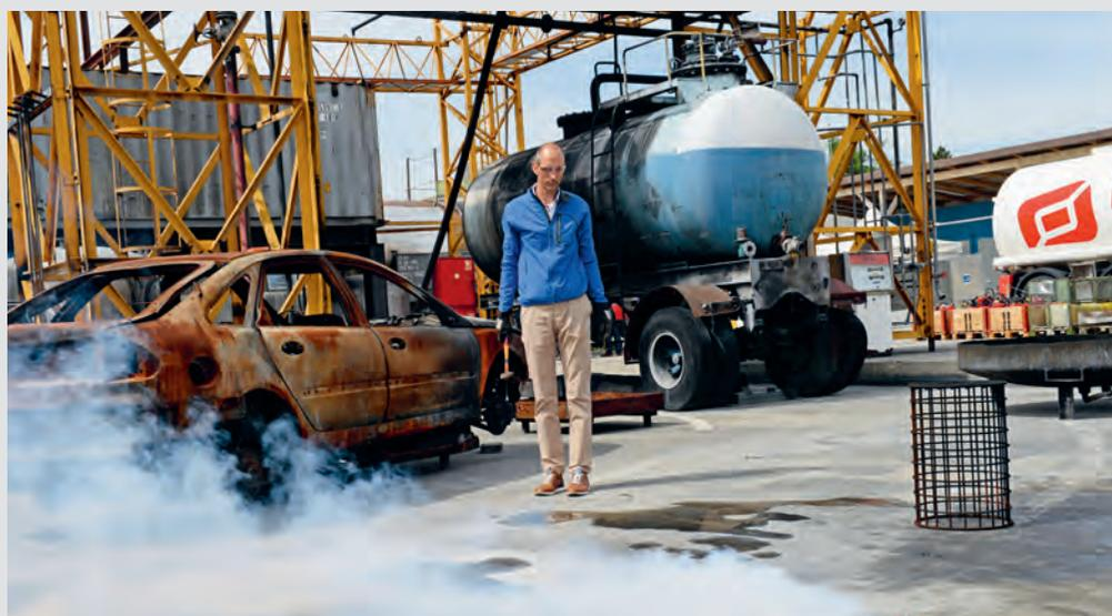
Essai d'incendie sur une batterie au lithium
