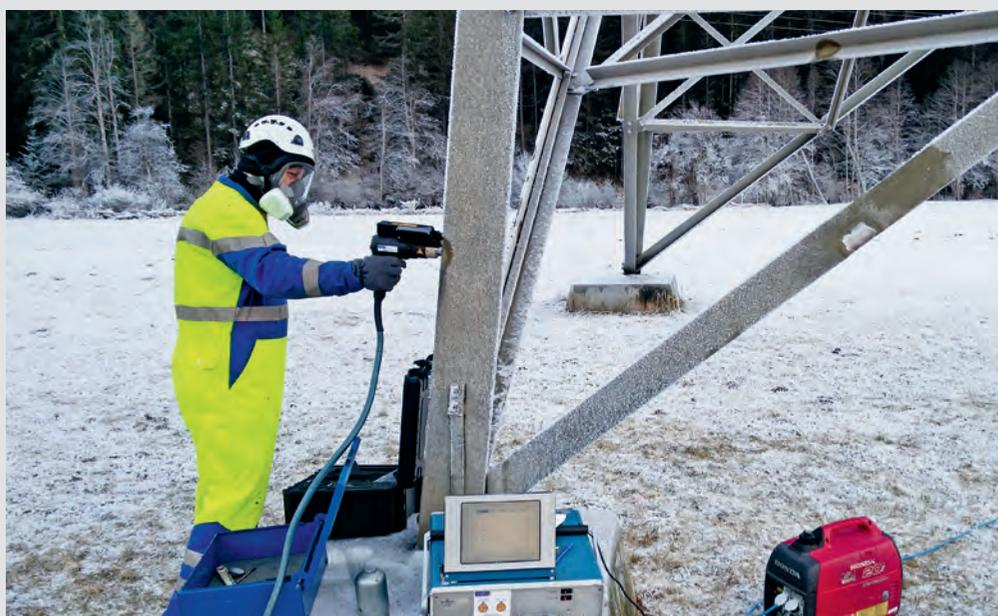
Contrôle mobile (vérification de la fragilisation due à l'âge) sur des pylônes de haute tension
