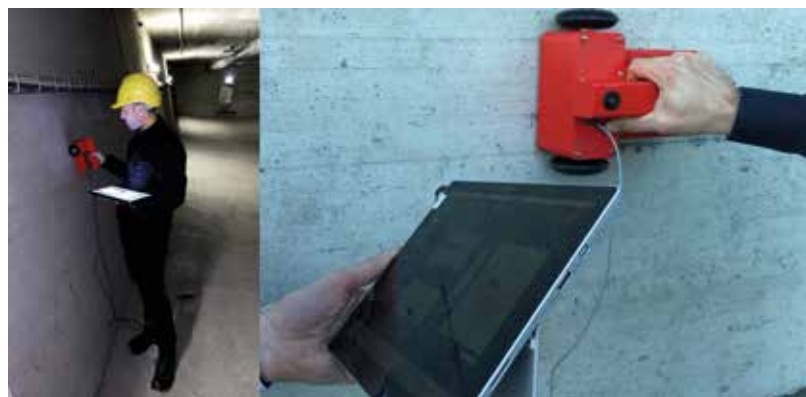
Abbildung 10: Rollscanner ECHOLYST Cart. Impact-Echo-Messungen mit Radencoder und in Luftankopplung.
