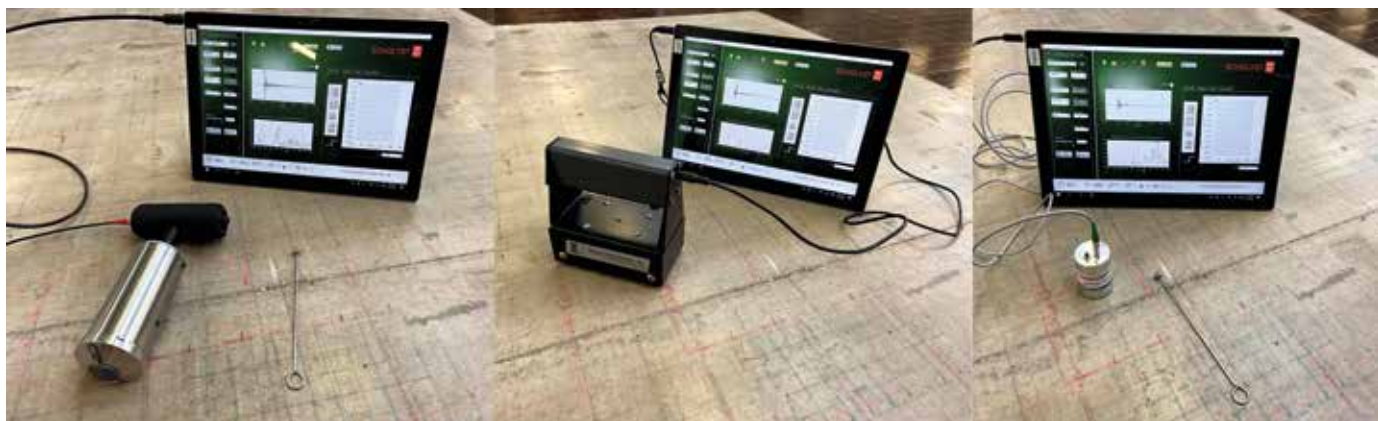
Abbildung 3: Direkter Anschluss gängiger Impact-Echo-Messköpfe über die Soundkarte an ein Windows Notebook.
